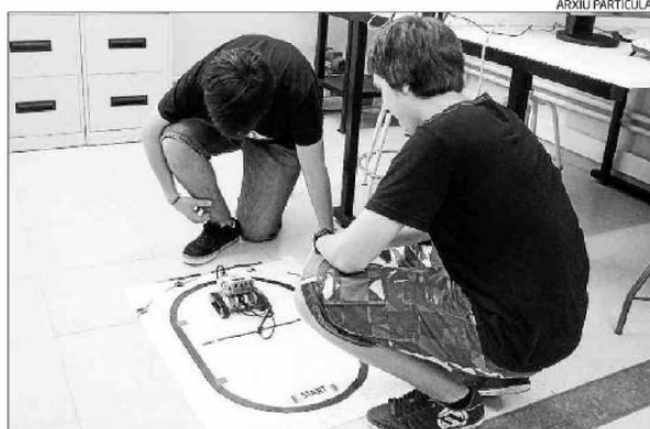
Imatge d'un mecanisme capaç de seguir un circuit marcat a terra
